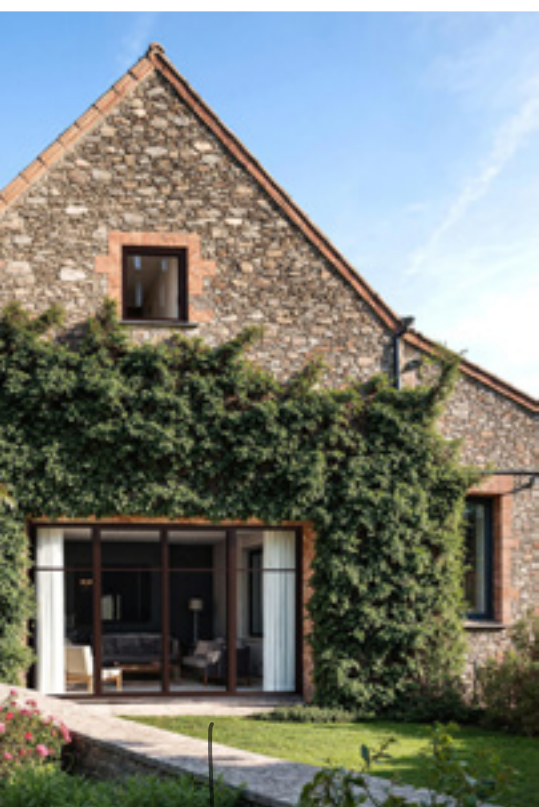
PORTE-FENÊTRE COMPOSÉE 2 vantaux avec 2 fixes latéraux, niveau Exigence. Teinte 8011 G. Plat aluminium de 30 mm. Vitrage ECLAZ® ZEN.
