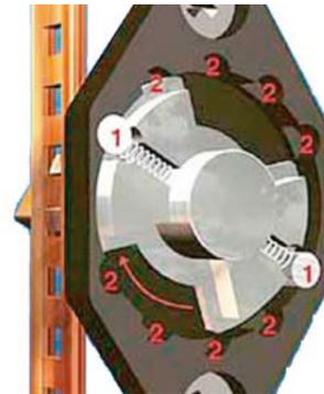
Les goupilles de sécurité (1) montées sur ressort s'engagent dans des évidements spéciaux prévus dans le logement (2) et produisent alors le cliquetis typique de la poignée **Secustik®**, le plus "sécurité" qui s'entend.
