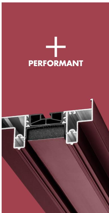
Système d'isolation et d'étanchéité intégré dans la traverse haute. Afin de faciliter la mise en œuvre et optimiser le confort à l'usage, une mousse isolante à mémoire de forme, revêtue d'un film glissant est assemblée dans un profil en U PVC.
