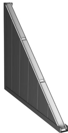
Panneau aluminium isolé de 27 mm avec grain d'orge d'un pas de 85 mm. Épaisseur de l'aluminium 9/10 mm laqué.
